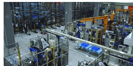
分散セル方式 による第5工場 でのロボット 生産の様子
