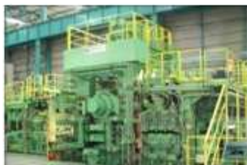
冷間延圧延機
