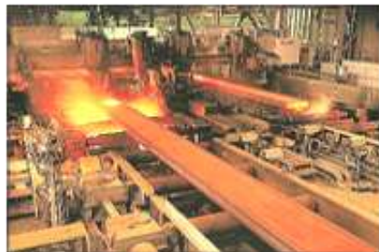
連続鑄造設備
