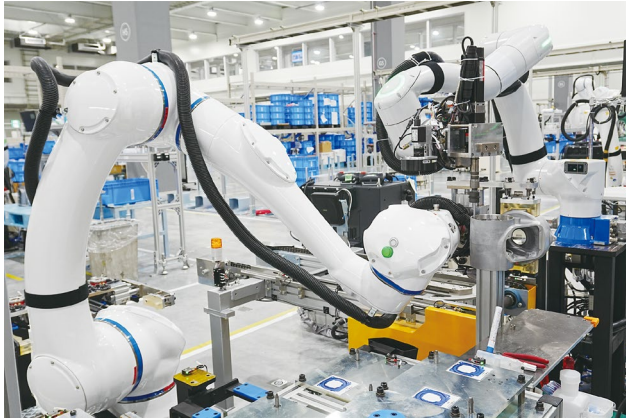
ねじ締めを行う自律型AIロボット「MOTOMAN NEXT(NHC12)」
