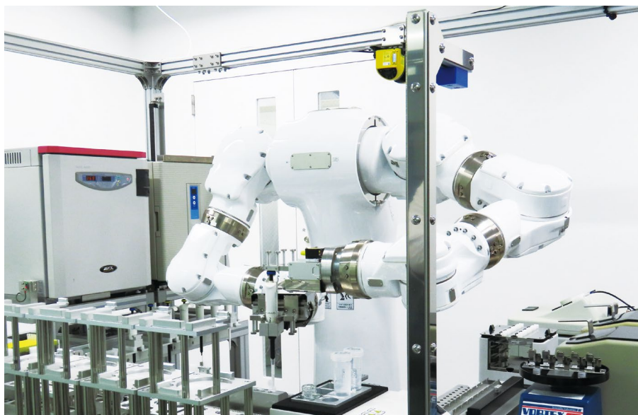
細胞製造プラットフォームで稼働する汎用ヒト型ロボットLabDroid「まほろ」
