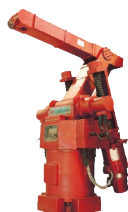
MOTOMAN-L10(1977年) 日本初全電気式垂直多関節産業用ロボット
