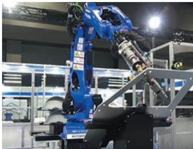
自動車部品の生産変動に対応する フレキシブルスポット溶接セル
