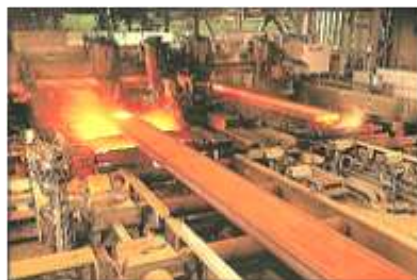
連続鑄造設備
