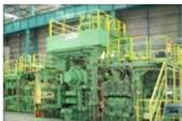
冷間延圧延機
