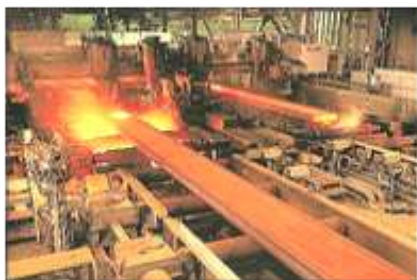
連続鑄造設備
