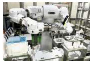
細胞製造プラットフォームで稼働する汎用ヒト型ロボットLabDroid「まほろ」
