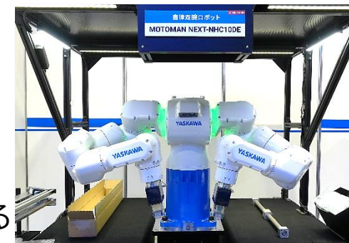
梱包作業を実現する 双腕型のAIロボット(MOTOMAN NEXT)
