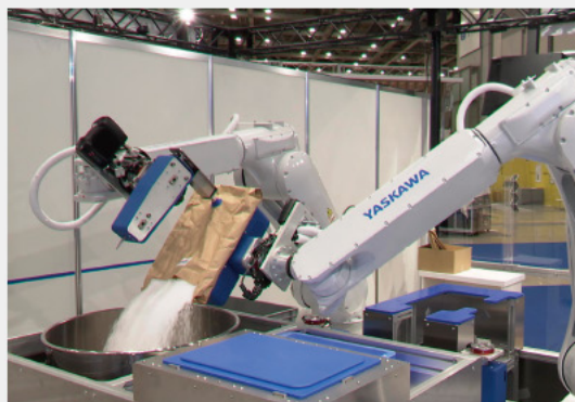
MOTOMAN NEXTによる原材料投入ソリューション
