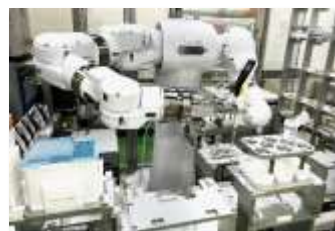
細胞製造プラットフォームで稼働する 汎用ヒト型ロボットLabDroid「まほろ」
