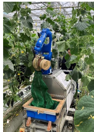
ゆめファーム全農SAGAにて稼働中の きゅうり葉かき・収穫ロボット
