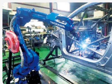
ロボットによる作業(SFA工法)
