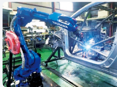
ロボットによる作業(SFA工法)
