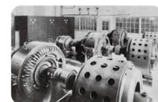
高炉原料自動装入装置用電気品
