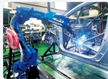
ロボットによる作業(SFA工法)
