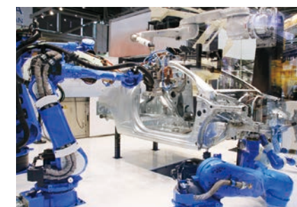
スポット溶接
