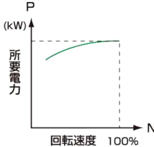
インバータがないと、モータの回転速度を変えられないので、ダンパ(開閉弁)で風量を調節
