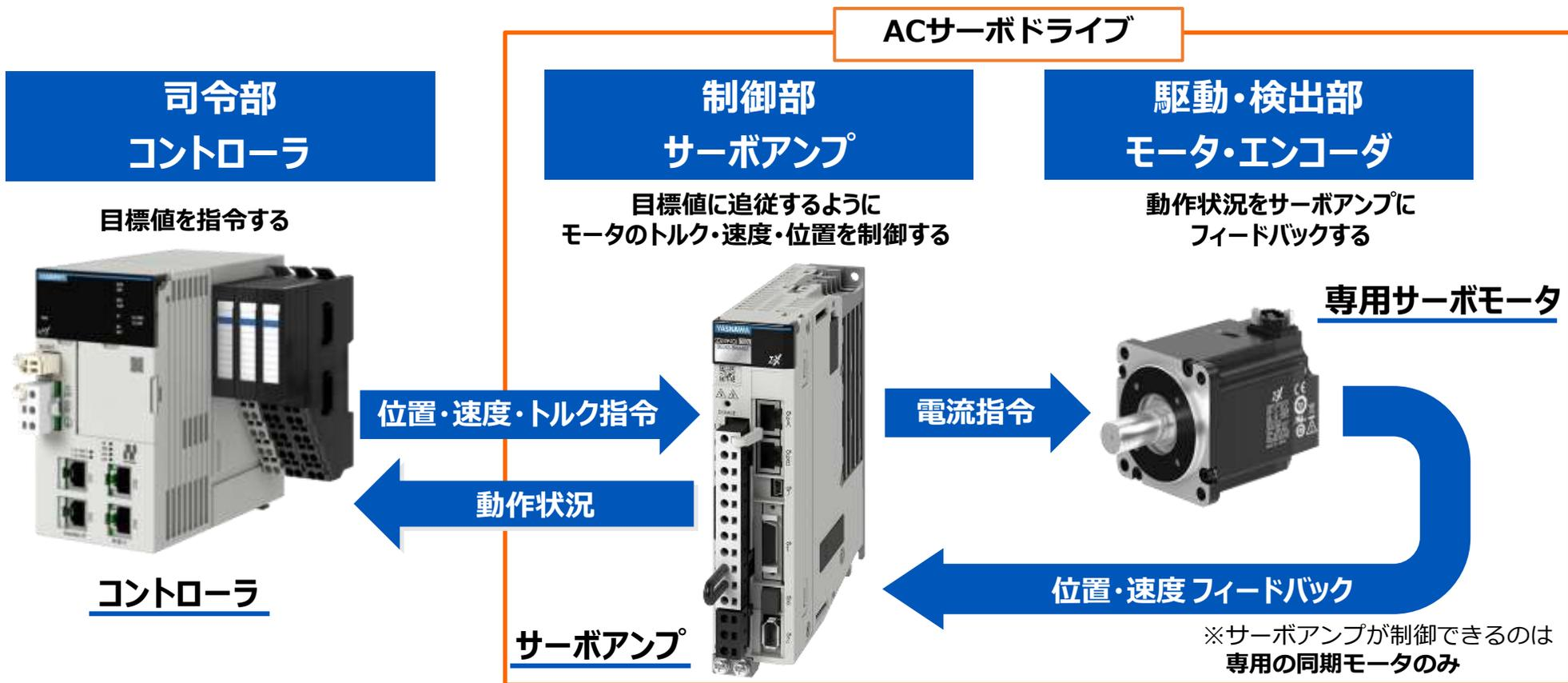
目的は高精度な位置・速度・トルク制御による装置性能の向上や品質の安定
