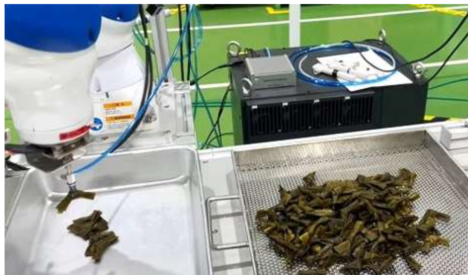
AIを活用し結び昆布の“結び目”を正確にピッキングするロボット
