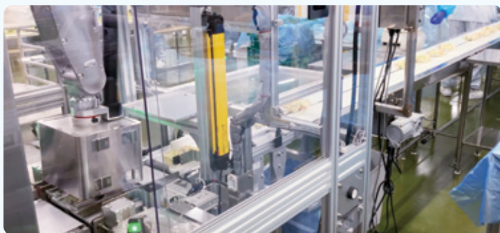
ふた閉めロボット稼働の様子
