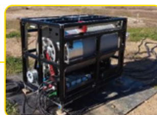
ワイヤを巻き上げる機械に 当社のサーボモータを使用
