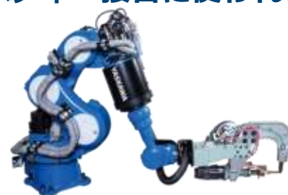
SP100B 7軸構造で高密度配置を実現
