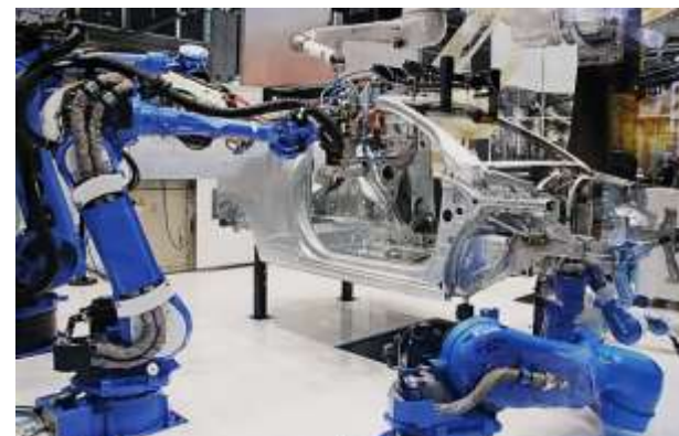
SP225H スポット機装に特化した中空構造
