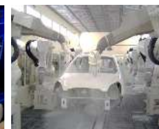
車体塗装システム
