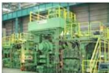
冷間延圧延機
