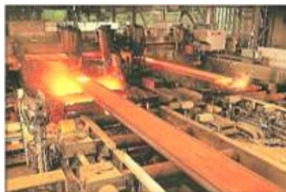
連続鑄造設備
