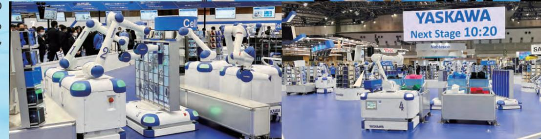
\* Autonomous Mobile Robot : 磁気テープ等の誘導体なしに自律的に走行する移動体。
