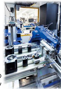
安川ソリューションファクトリの ACサーボモータ生産ライン
