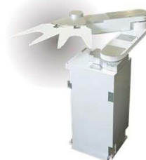
新型半導体ウエハ搬送用クリーンロボット 「SEMISTAR-GEKKO MD124DJ」
