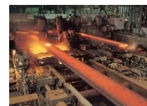
連続鋳造設備
