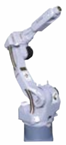
MOTOMAN-UP6 世界初 複数ロボット協調制御
