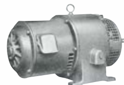
VSモータ1号機5HP 可変速電動機
