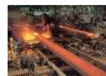
連続鋳造設備
