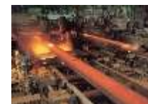
連続鋳造設備
