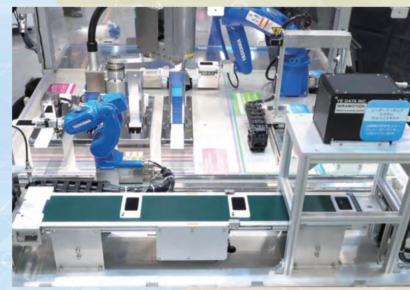
AI・IoTのエッジソフトウェア「YASKAWA Cockpit」と「ロボットモジュールによるロボットと装置の融合」を、スマートフォン製造ラインの組立・検査装置に適用したデモ機です。データの見える化、BTO生産を実現するフレキシブルな生産ラインを実現できます。
