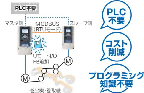
インバータマスタ/スレーブ通信制御による巻取機制御の例
