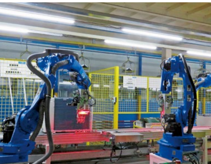
エアコン室外機の組み立て
