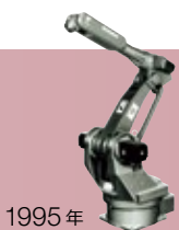
1995年 MOTOMAN-SK16 自社ACサーボモータシリーズ採用 徹底した軽量化・スリム化
