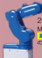
2016年 MOTOMAN-GP8 動作能力を格段に向上した新小型ロボット
