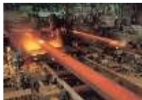
連続鋳造設備
