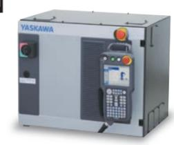
新形ロボットコントローラYRC1000
