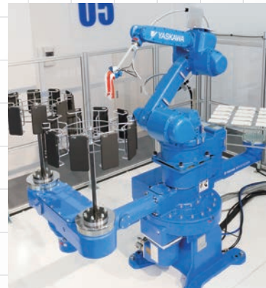
塗装最適化ロボット (CSプラザ)
