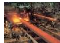
連続鋳造設備
