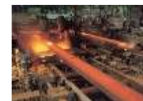
連続鋳造設備
