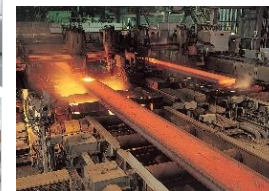
連続鋳造設備
