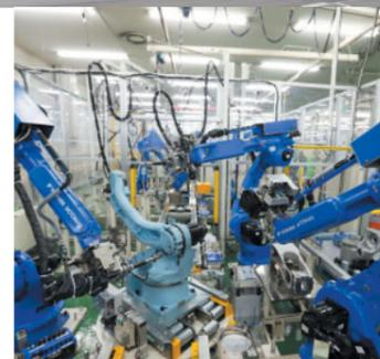
第1工場では、1990年世界で初めてロボットがロボットを作る工場として誕生して以来、常に最先端のロボットを投入し、アーク溶接、ハンドリング用途の小型ロボットを製造しています。
