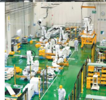
第2工場は液晶ガラス基盤搬送用ロボットや大型真空ロボットなど、クリーンな環境で使われるロボットを製造しています。
