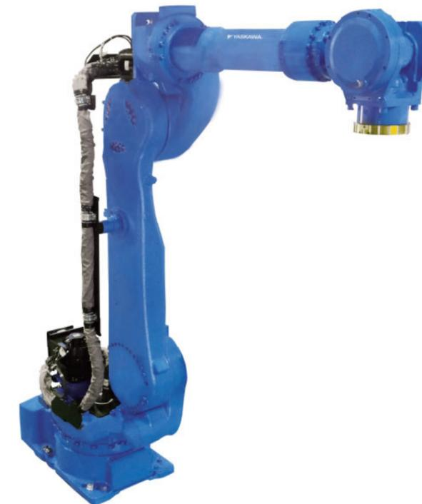
主な用途 | 肥料・飼料・粉体等の袋包装物のパレタイズ、袋詰め充填機の払い出し工程等、各種パレタイズ用途
