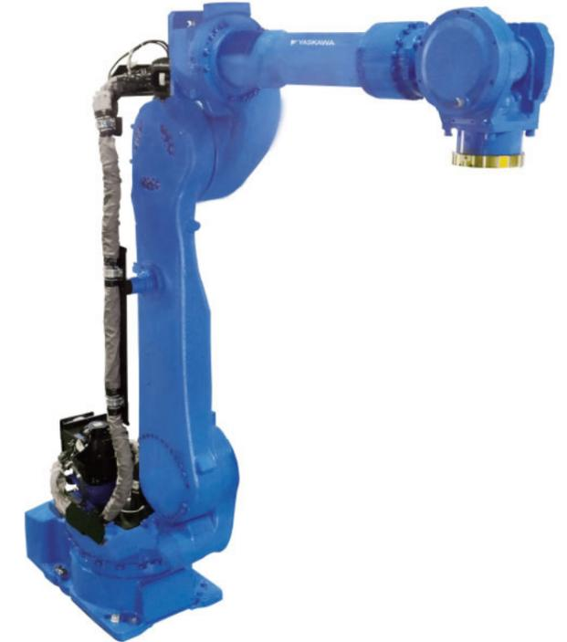
**主な用途** 肥料・飼料・粉体等の袋包装物のパレタイズ、袋詰め充填機の払い出し工程等、各種パレタイズ用途
