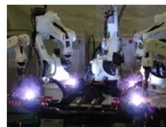
4台のロボットによる 協調溶接
