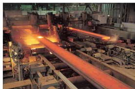
連続 casting 設備
