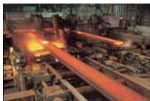
連続鋳造設備
