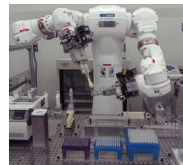
バイオメディカル分野向け 分析前処理ロボットシステム
