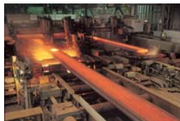
連続鋳造設備
