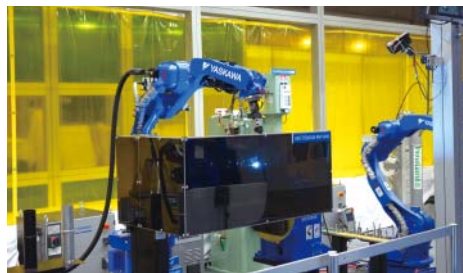
アーク溶接のスパッタ量を大幅削減したEAGL工法のデモンストレーション
