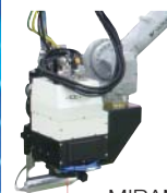
MIRAMOTION搭載ハイパワーレーザ対応スキャナヘッド
