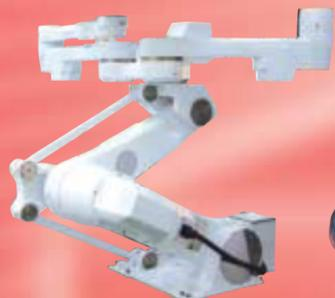
大形液晶ガラス基板搬送用ロボット MOTOMAN-CSL2400D
