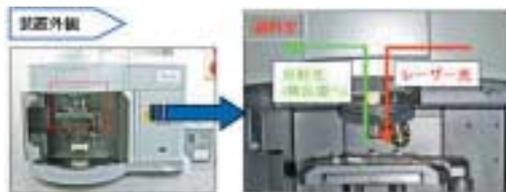
1μmφのレーザー光を使用し、非破壊で成分及び微小領域のひずみや結晶状態が解析可能なため、材料の信頼性評価ができる、レーザーラマン分光光度計
