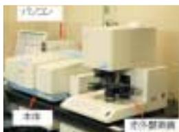
ごく微小な有機物の材質を特定できる、顕微FT-IR（フーリエ変換赤外分光光度計）
