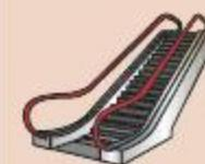
エスカレータの場合、人を乗せていない時は停止していますが、人が近づくと「PWM制御」で加速します。高速時(一定速)になると「商用電源運転」に切替えます。エネルギーロスや騒音の低減はもちろん、位相検出器やコンタクタが不要で配線が簡単です。
