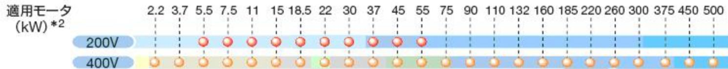
\*1: 260kW以上は、計画中です。 \*2: 目安です。選定については、定格出力電流がモータ定格電流以上となるように機種を選定してください。
