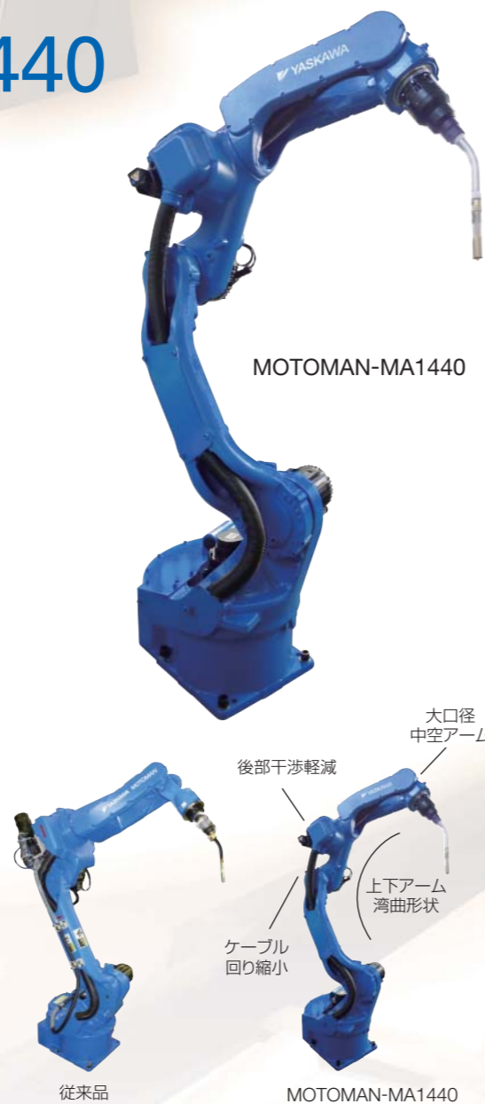
外付形は、円形溶接のロボット動作に最適。
