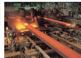
連続鋳造設備
