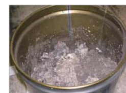
リサイクル前のはんだ屑
